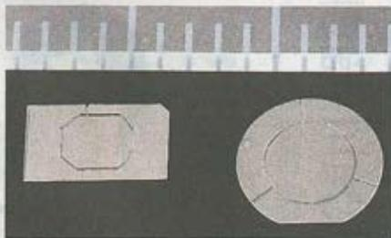
中央部を薄くした超高周波タイプの水晶素板。世界でグローバルのみが取り入れている特殊製法で加工した
